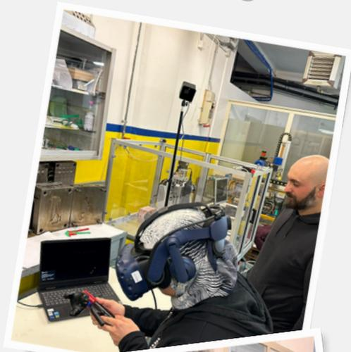
La saldatura virtuale è un sistema di saldatura innovativo, virtuale ma reale al 100%, che permette di acquisire una conoscenza di base oltre ad approfondire degli aspetti tecnici a tutti i livelli, utilizzando i vari processi di saldatura utilizzati nel mondo del lavoro.
